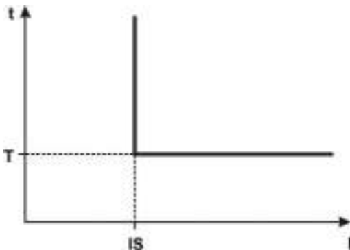
Рисунок 4 – Принцип защиты с независимой выдержкой времени
