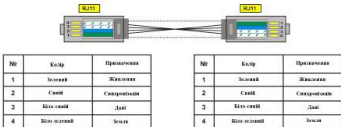
Рисунок 5.2 – Нумерація виводів кабелю KMP-11-1
