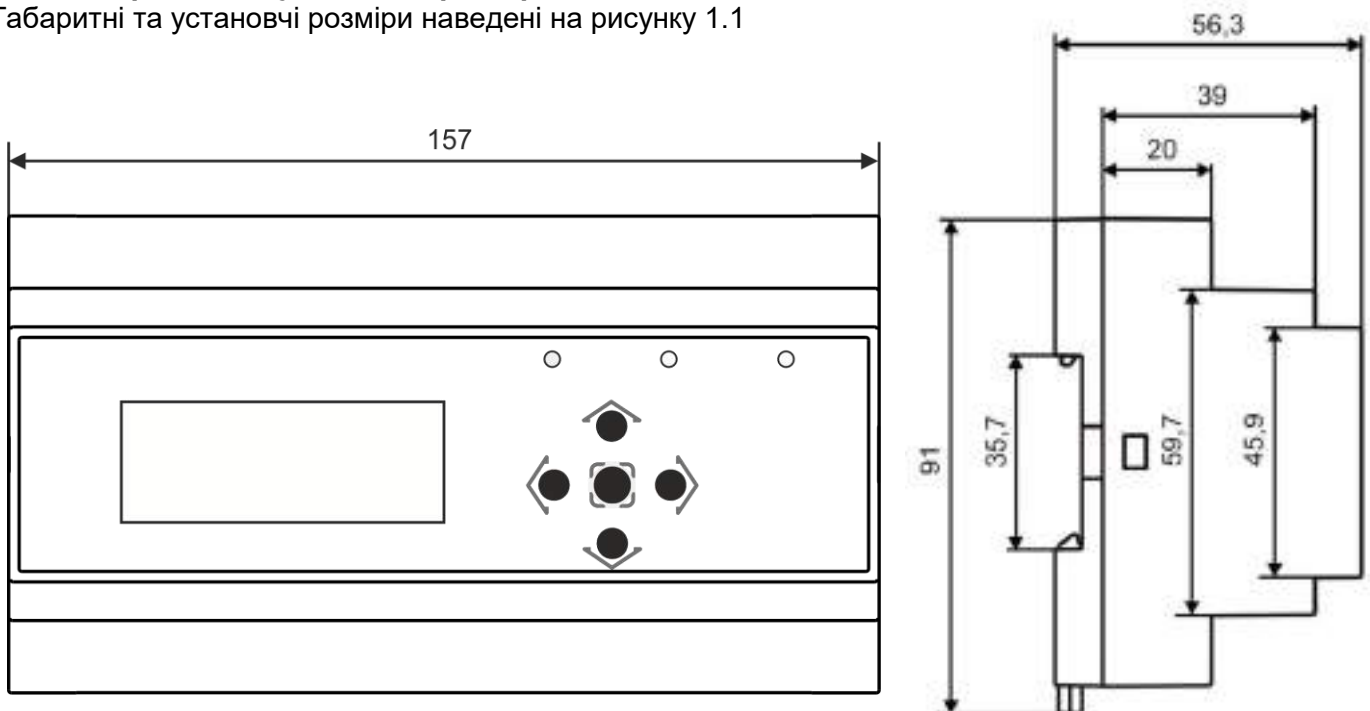
Рисунок 1.1 – Габаритні і установчі розміри реєстратора
