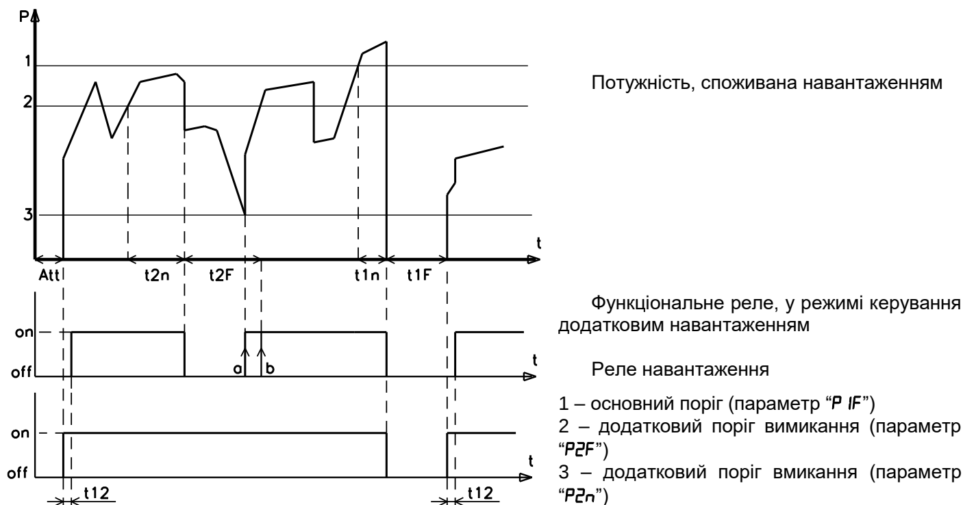
Рисунок 1.3 – Робота OM-310 у режимі обмеження потужності при rrS=2
