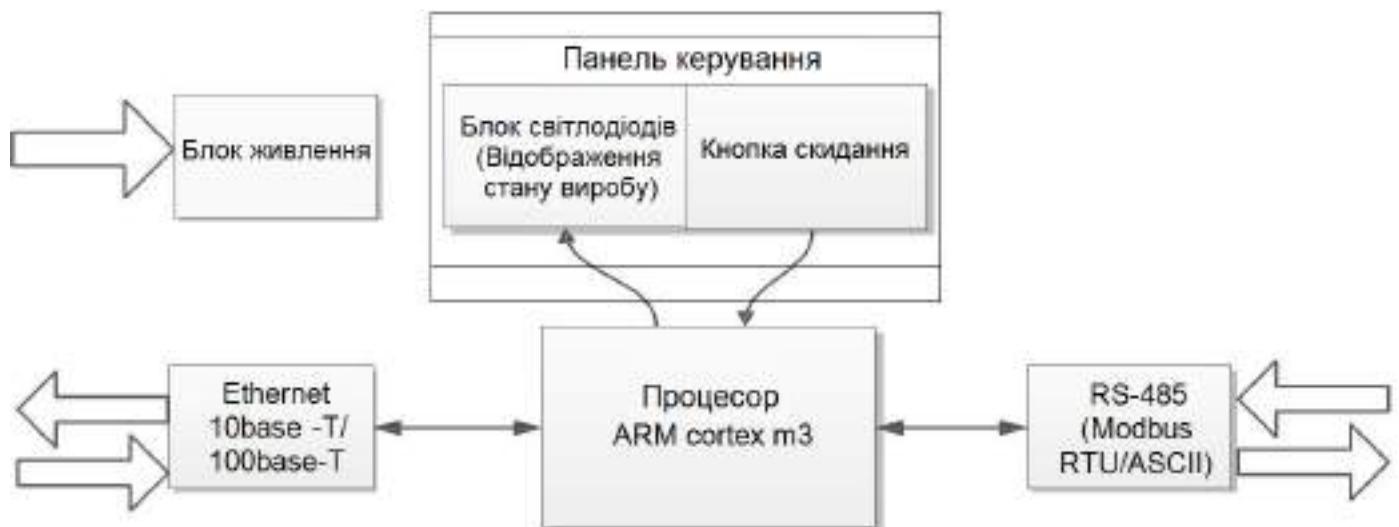
Рисунок 3 – Структурна схема виробу
